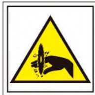
RIESGO DE CORTE ATENCIÓN MANOS
