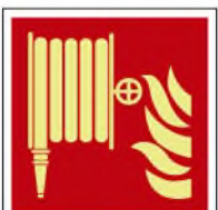
BOCA DE INCENDIO
