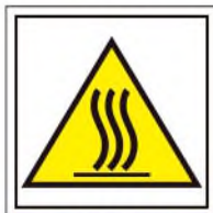
¡PELIGRO! DE CONTACTO TÉRMICO
